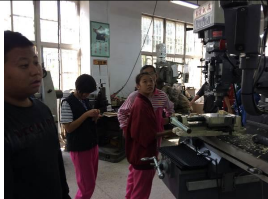
日期：105.12.17 地點：機械科館 照片敘述：銑床加工魯班鎖-六子連方
